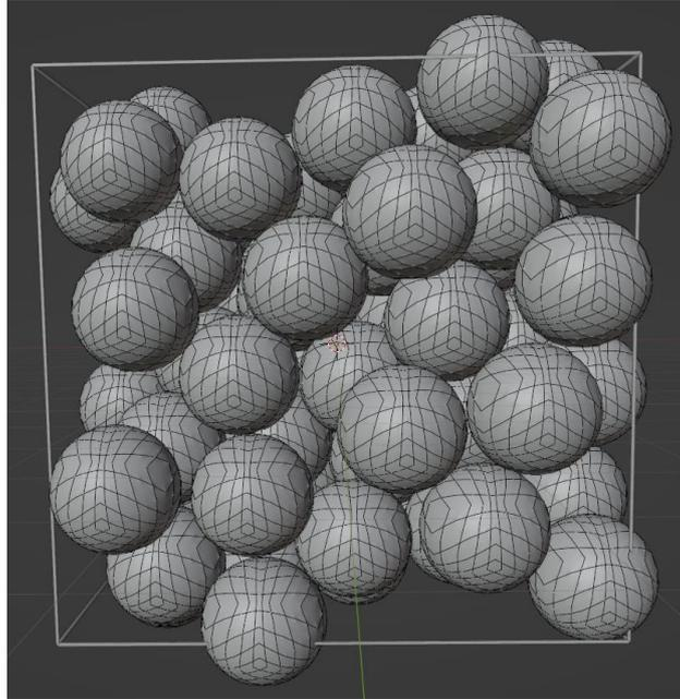
**Abbildung 14:** 3D-Ansicht des Systems für harmonisch Abstossendes Potential, isotrop,  $N = 100$ ,  $\Phi = 0.625$ , Blickwinkel von der Seite aus Richtung  $+y$
