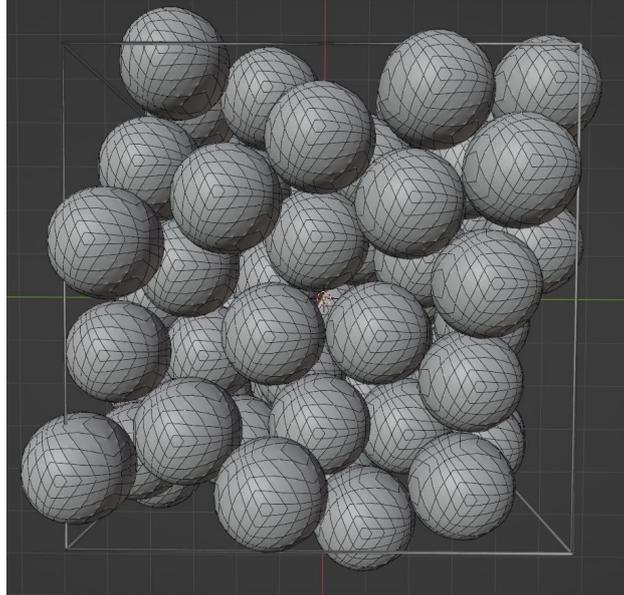
**Abbildung 15:** 3D-Ansicht des Systems für harmonisch Abstossendes Potential, isotrop,  $N = 100$ ,  $\Phi = 0.625$ , Blickwinkel von oben
